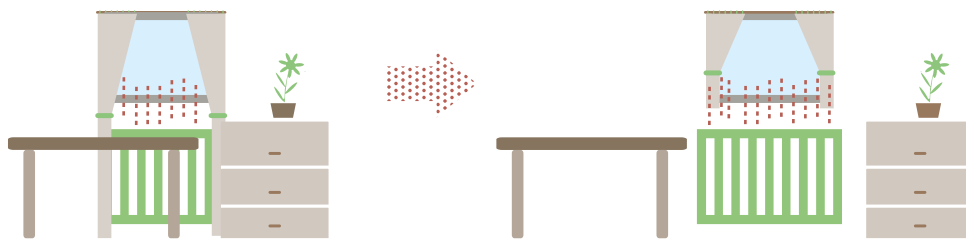
schlechte Wärmeabgabe durch verdeckte Heizkörper
