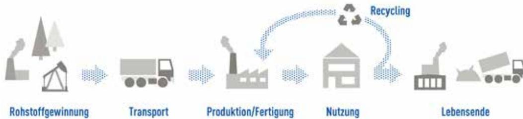
Abb.: Zur ökologischen Beurteilung eines Baustoffes ist es wichtig den gesamten Kreislauf von der Rohstoffgewinnung über die Herstellung bis zur Wiederverwendung bzw. Entsorgung zu berücksichtigen.
